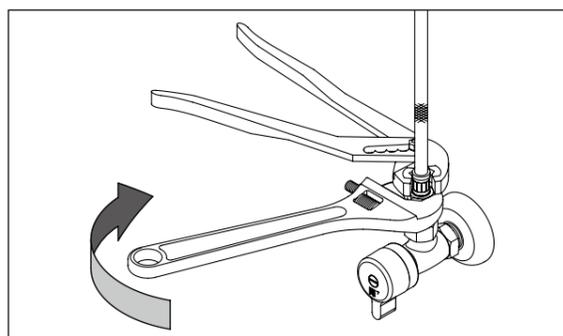
②フレキシブルホースが動かないようにレンチ等で押さえながらナットをスパナー等で増し締めします。締め付けトルクは目安として 5 ~ 7N・m です。
