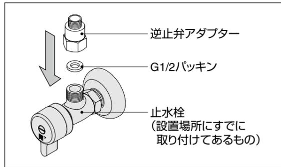
①止水栓と逆止弁の間に G1/2 パッキンを入れ、逆止弁を手でしっかり締めます。
