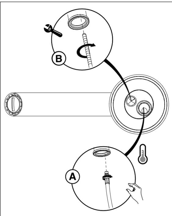
①フレキシブルホースを時計回りに回し、本体に手締めでしっかりねじ込みます [A]。
