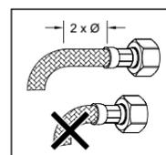
ホースを曲げる場合は、ホース差し込み口からパイプの外径の約2倍の長さ以上の直線部分を維持してください。
