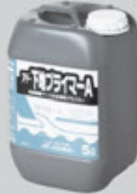
ベニヤ下地・石膏ボード等の吸水率がある下地へ塗り、その後セメントベースの接着剤などで床壁材を施工する。
